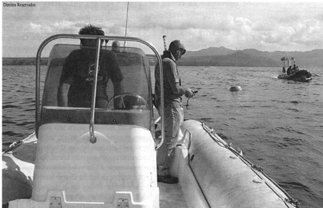
Colocação da bóia ondógrafo ao largo de Vila do Porto
