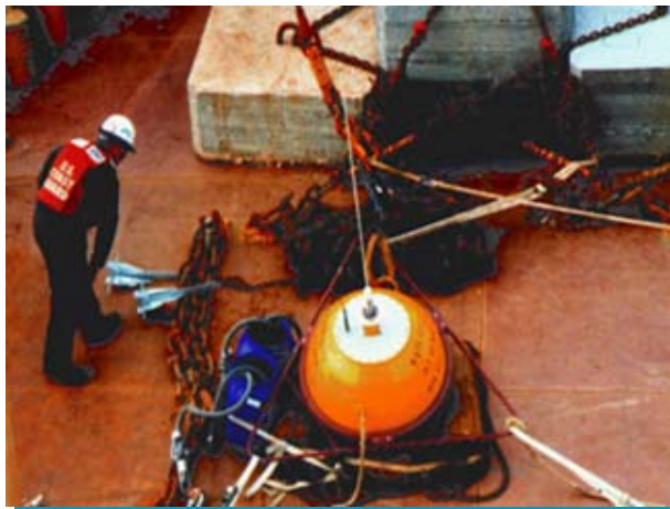
Fig 4 – Fundear Bóia Ondógrafo c/ amarração e poita
